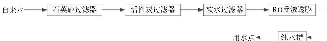
图 2.9-3 纯水制备工艺流程图
